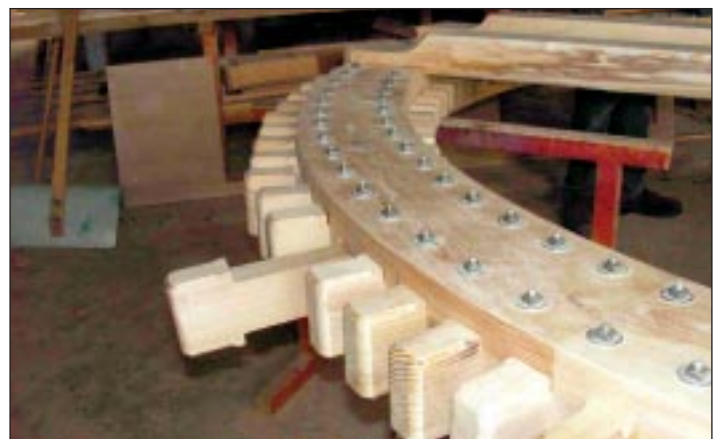
Nemcsak a Dunán haladnak a munkálatok, hanem a műhelyekben is. Elkészült a 2,5 méter átmérőjű fogaskerék, Viski György asztalmester vezetésével. A fogakat Tapodi Attila készítette
