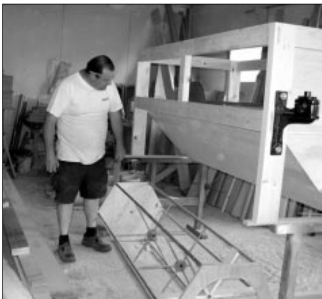
Kiss Zsolt asztalos készíti a drótszita-szekerényt. Ez egy durva szita, az áthullott őrleményt egy tolócsiga a selyemszitába továbbítja, ami a finomszitálást végzi
